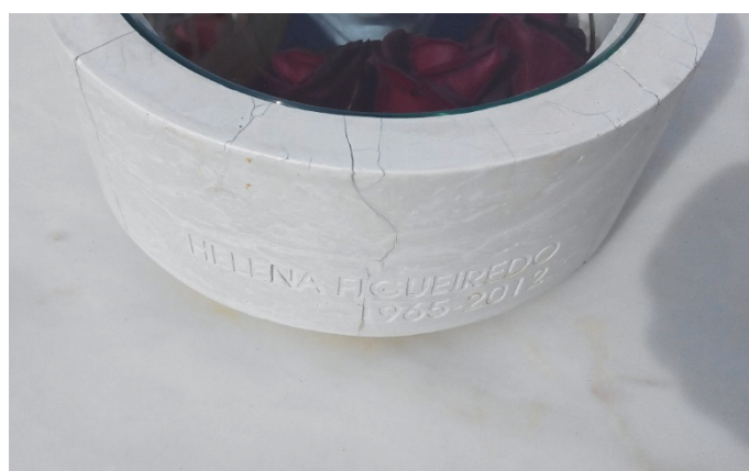
Fig. 22 - Fissuras na parede do protótipo
