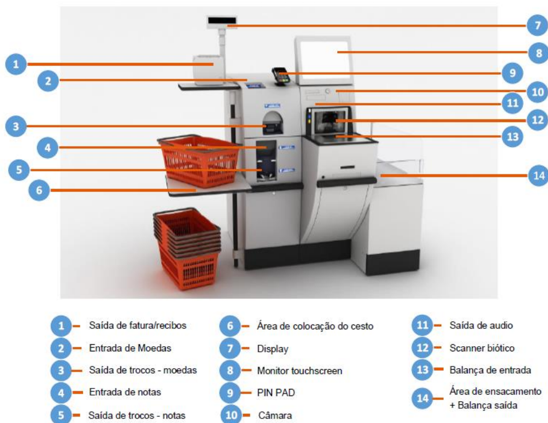
Fig. 1 - Periféricos do Self-Checkout Tipo (adaptado de Wired, 2019)
