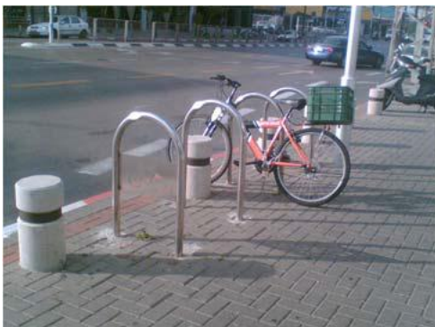
Figura 3: Soporte U invertida
